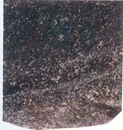
灰黑色油浸含细砾的粗粒砂岩，油浸不均匀，显示清晰的小型槽状交错层理。
